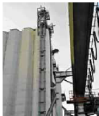
Abb. 1: Becherelevator zum Befüllen von Silos.
